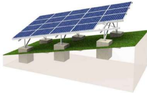
Bild 53. Exempel på betongelementfundament som grävs ner i marken (Xiamen BROAD New Energy Technology Co. 2024).
