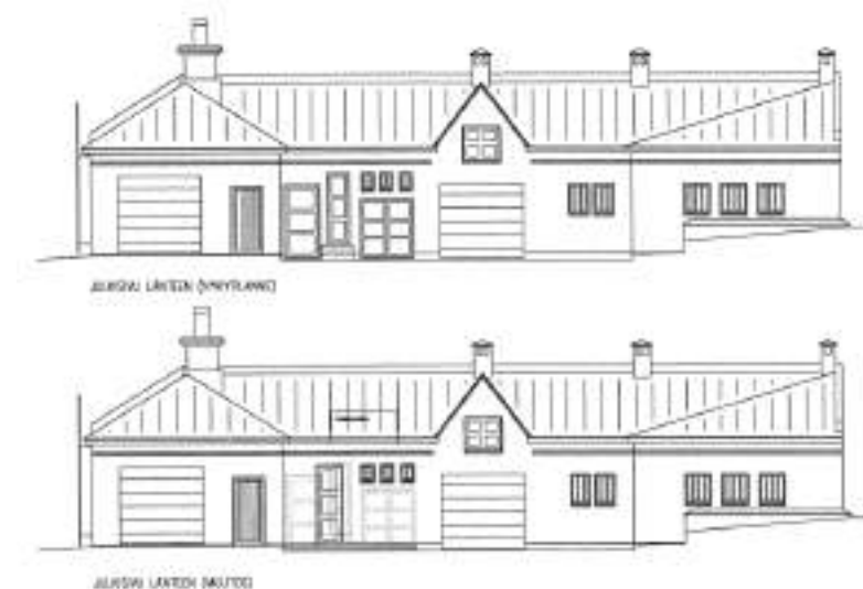
Bild 34. Ändringar i gårdsbyggnaden 2001: för flisbrännaren gjordes en försänkning i golvet och öppningar i fasaden murades igen.
