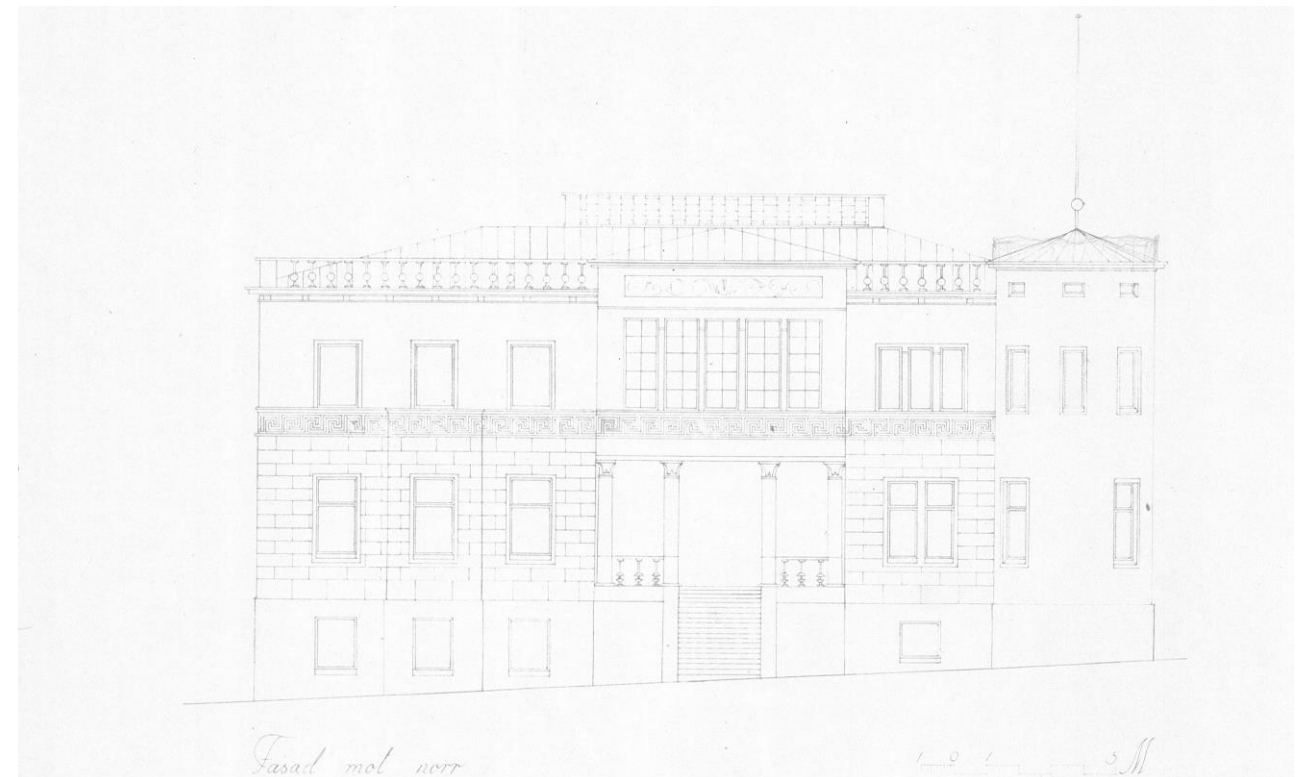
Bild 14. Norra entréfasaden. Byggnadsmassan på vänstra sidan av entrén höjdes till två plan, tornmotivet tonades ner till ett burspråk och sadeltaksformen på takfoten revs. Öppningarna i fasaden gjordes mer enhetliga. Ornamentsmotivet på balkongräckshöjd löper runt fasaden. Ornamenten i övre delen av tornet avlägsnades och taket gjordes mindre brant.
