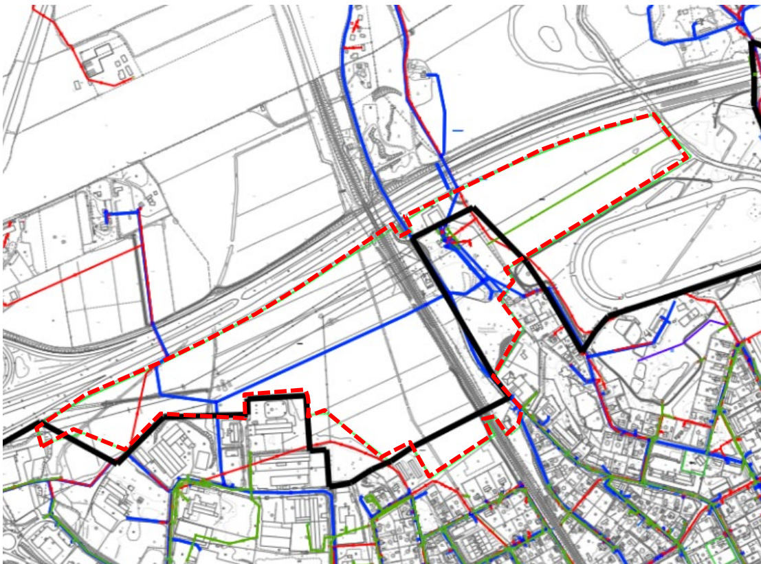
Kartutdrag över underjordiska rör. Bruksvatten i blått, spillvatten i rött, dagvattenavlopp i mörkgrönt. Gräns för vattenverkets verksamhetsområde i svart.
