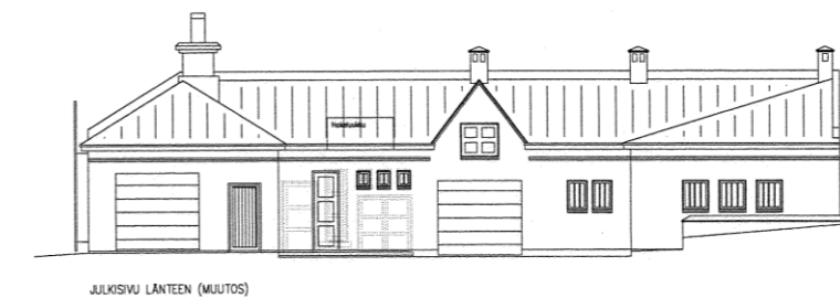
JULKISIVU LÄNTEEN (NYKYTILANNE) JULKISIVU LÄNTEEN (MUUTOS) Kuva 34. Piharakennuksen muutokset vuonna 2001, hakepoltinta varten tehdään lattiaan syvennys, julkisivun aukkoja muurataan umpeen.
