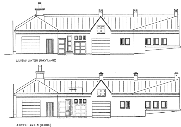
Kuva 34. Piharakennuksen muutokset vuonna 2001, hakepoltinta varten tehdään lattiaan syvennys, julkisivun aukkoja muurataan umpeen.
