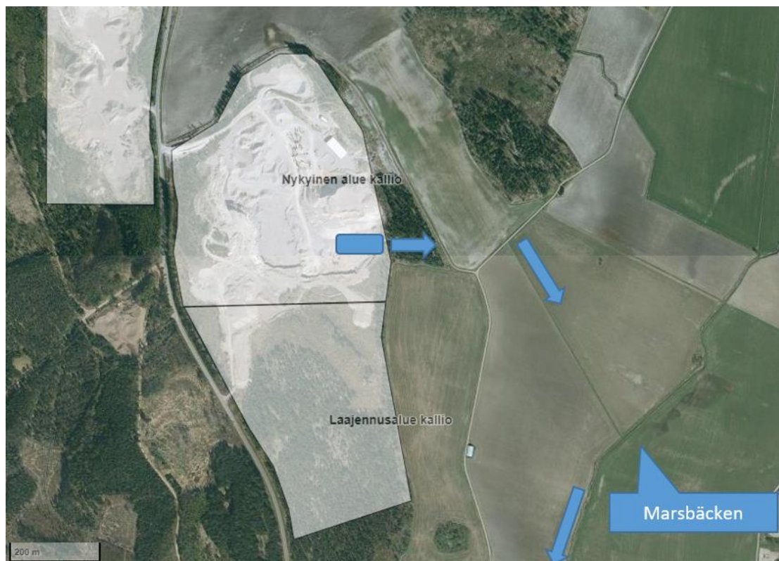
Kuva 36. Pintavesien johtamisreitti hankealueelta (kallio) pelto-ojia pitkin Marsbäcken-ojaan. Viivytysaltaan likimääräinen sijainti on merkitty sinisellä suorakulmiolla. Ilmakuva Maanmittauslaitos.
